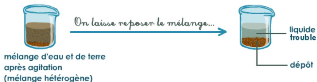
Lors d'une décantation, les particules en suspension se déposent au fond du récipient avec une vitesse de sédimentation. La séparation obtenue est parfois partielle, il
